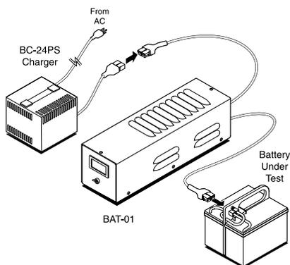
Fig. 8.3 BAT-01 Strumento per l'analisi della batteria
