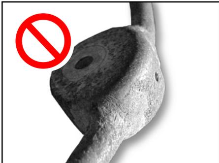
**Anodo con evidente copertura di ossido.**
